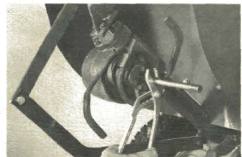
(Photo 8/75) Pliers tighten stud.
