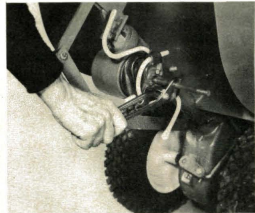
(Photo 8/87) Install tine stud.
